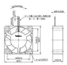
使 用 材 料 ハウジング:プラスチック (UL: V-0)
