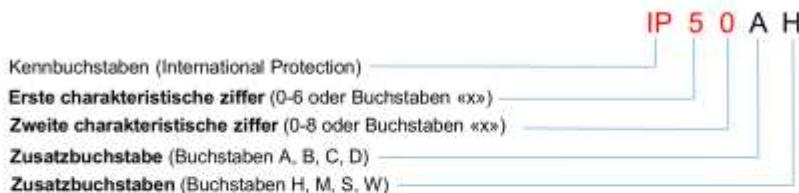
Die **erste Ziffer** zeigt den Schutzgrad gegen das Durchbohren seitens von **Fremdkörpern**.
