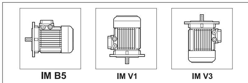
Los motores embriddados pueden suministrarse con dimensiones de acoplamiento reducido, como queda indicado en la tabla - ejecuciones **B5R**. Su uso en combinación con los reductores debe ser coherente teniendo en cuenta la máxima potencia instalable en los mismos (ver apartado "Predisposiciones motor"). En el caso de que no se cumpla esta condición deberá contactar con el Servicio Técnico para comprobar la combinación.
