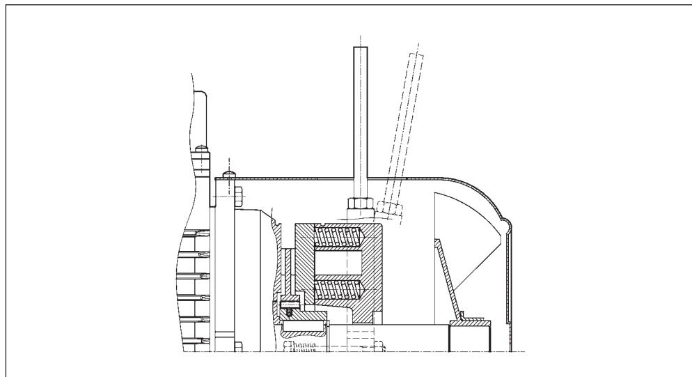
La palanca de desbloqueo incorpora el retorno automático a través de un dispositivo demuelles.
