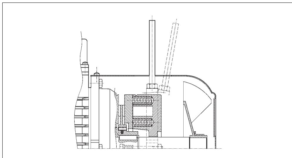
En los motores freno tipo FD la palanca de desbloqueo puede fijarse temporalmente en posición de desbloqueo del freno, ajustando la misma hasta sujetar la extremidad en un resalte del cuerpo del freno.
