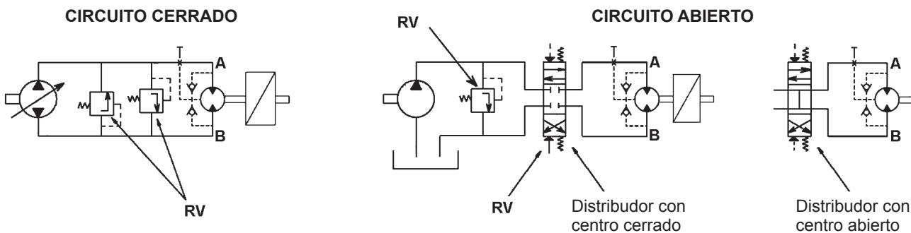
En el caso que esto no sea posible, cuando el circuito tenga que controlar otros accionamientos con presión más elevada, y/o en el caso que se disponga de un distribuidor con centro cerrado y el motor accione órganos con un momento de inercia elevado, es necesario montar las válvulas secundarias de máxima presión, lo más cerca posible del motor. Ver esquema (A30).
