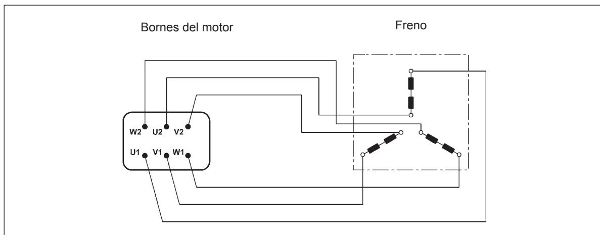
Para los motores de doble polaridad, y cuando se requiera, los motores de una velocidad con alimentación independiente, está prevista una regleta auxiliar con 6 bornes para la conexión del freno; en esta ejecución los motores incorporan una caja de bornes mayor. Ver esquema siguiente:
