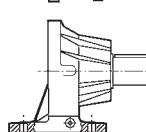
**PC:** Con patas y eje macho cilíndrico
