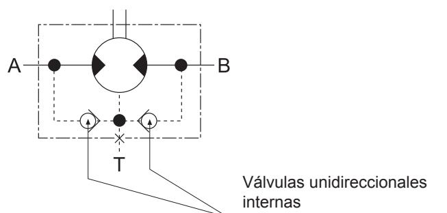
1) Si el drenaje está conectado, la presión sobre el retén del eje es igual a la presión del ramal del drenaje.
