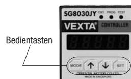
**● 48 mm × 48 mm DIN-Format und zwei Montagekonfigurationen sind verfügbar.**
