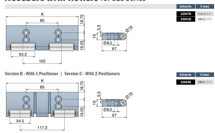
Rulli: Acciaio inox / Rollers: Stainless steel / Rollen: Edelstahl
